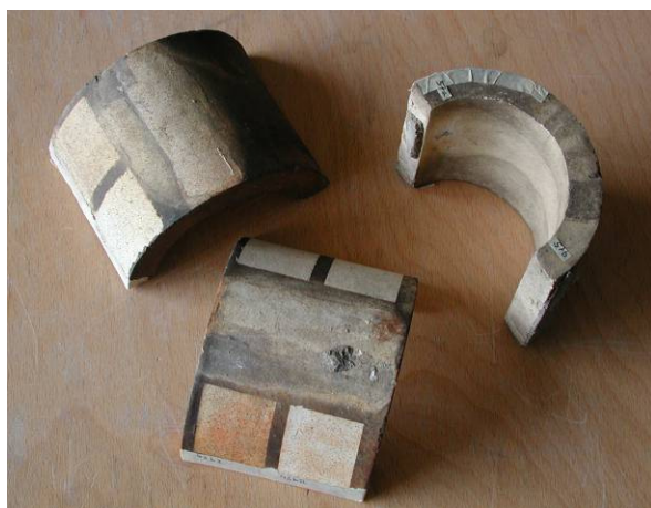
Abb. 70: Elemente eines Albanischen Gitters als Probekörper für Reinigungsversuche
