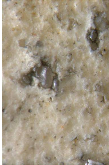
Abb. 81: Quarzkornumgebung (gereinigt, intakt)
