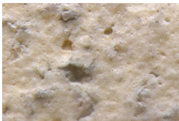
Abb. 88: Reinigungsmuster AG 42 b I, nach der Reinigung: Veränderung von Kraterrändern, Entstehung neuer „Löcher“, Einebnung des feinen Oberflächenreliefs
