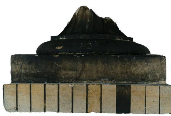
Abb. 73: Bruchstück 1 des Amphorenfußes mit Testfeldern systematischer Reinigungsversuche
