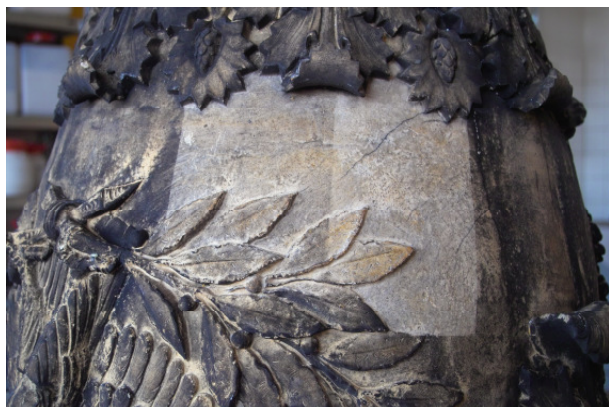
Abb. 100: Probeflächen zur Abstimmung der Reinigungsparameter
