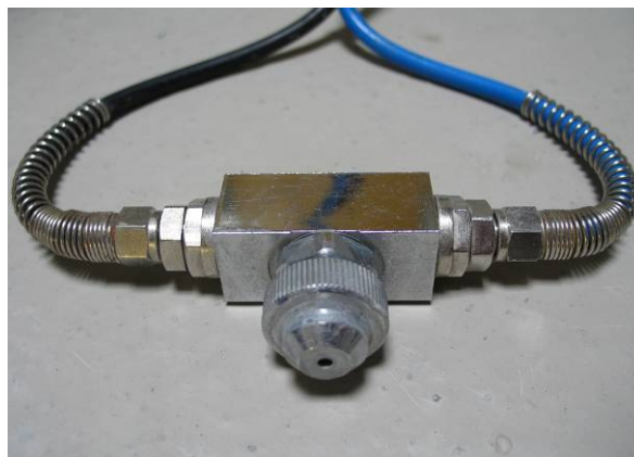
Abb. 75: Nebulizzatore: Düse mit Druckluft- und Wasserzufuhr
