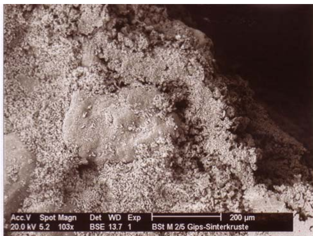
Abb. 139: Probe M 2/5: Querbruch. Rechts ist die Gips-Sinter- kruste zu erkennen. [REM- RE-Aufnahme]
