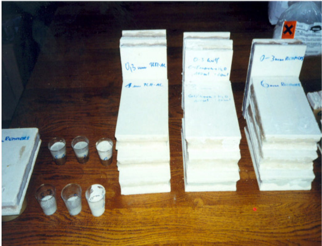
Abb. 7 (oben): Verbundprüfkörper 6x6 cm Abb. 8 (unten): Verbundprüfkörper 25x20 cm und Plexiglasbecher der Penetrationsversuche
