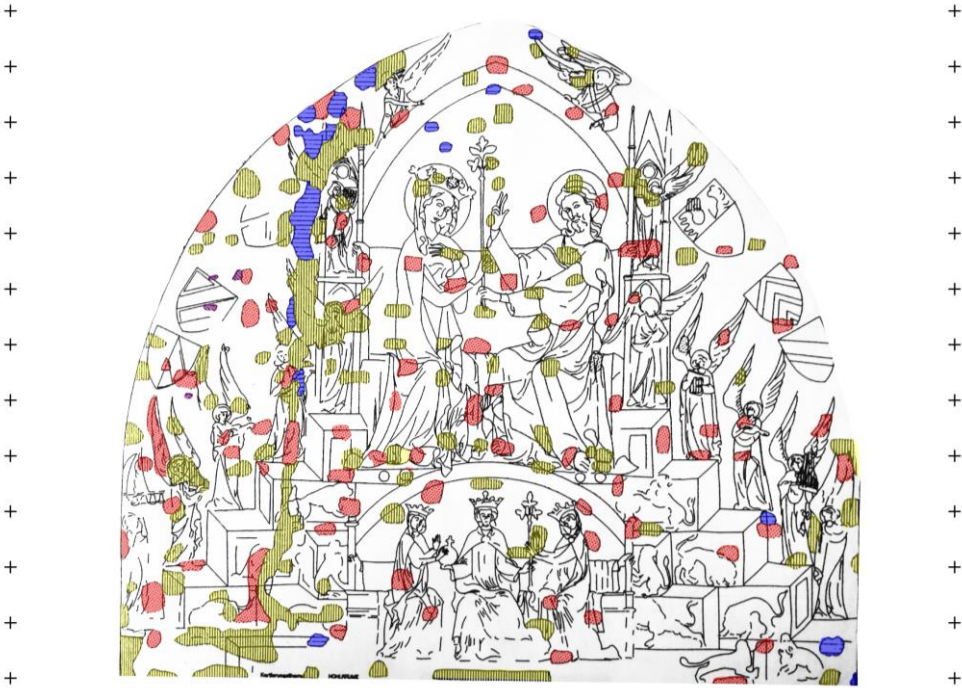
Abb. 7-3: 2023 > Die Kartierung von 1991 wurde digitalisiert, entzerrt und damit maßstäblich referenziert sowie digital nachkartiert (farbige Schadensklassen).
