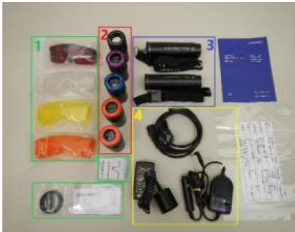
Abb. 1-30: Lumatec Superlite M 05 Kofferinhalt. 1-verschiedene Filterbrillen und Zubehör, 2-LED-Köpfe in den Wellenlängen 365nm, 405nm, 445nm, 620nm, 850nm, 3-Lichtquellen-Adapter, 4-Ladegerät mit Stromkabeln.
