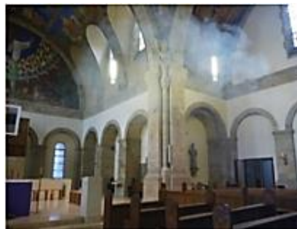
Abb. 1-26: Nebelversuch bei eingeschalteter Lüftung belegt, dass der „Nebel“ nicht in die Kuppel gelangt (b).
