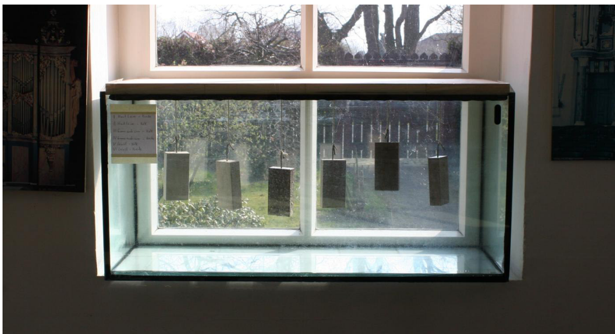
Abb. 47: Versuchsbehälter zum Test der Beschichtungen bei Essigsäure-Belastung
