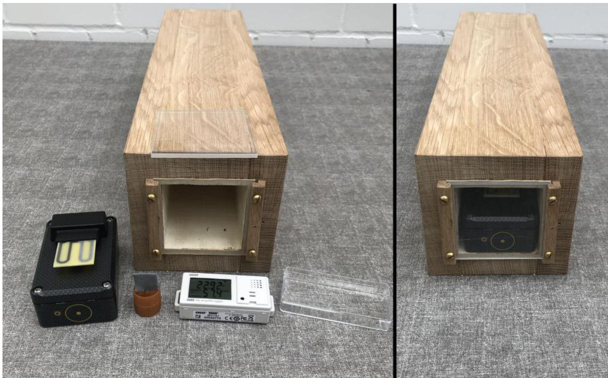
Abb. 43: Versuchsaufbau einer Probekanzelle: Wasserschälchen, HOBO Feuchte-/Temperatursensor, ein Bleicoupon, AirCorr-Messsystem mit Bleisensor
