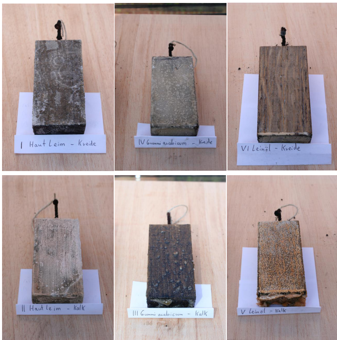
Abb. 48: Holzstücke mit Kreide (obere Reihe) bzw. Kalk (unter Reihe) und verschiedenen Bindemitteln beschichtet und eine Woche in einem geschlossenen Behälter über Essigsäure gehängt links: Hautleim mitte: Gummi Arabicum rechts: Leinöl
