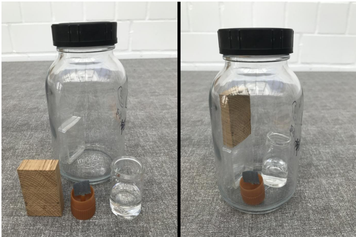
Abb. 20: Aufbau des Oddy-Testes, Schraubglas, ein Glas mit Wasser, ein Stück zu untersuchendes Holz, ein Bleicoupon. Alle Teile werden in das Schraubglas gegeben (rechts) und in einen Ofen bei 65°C ausgelagert.
