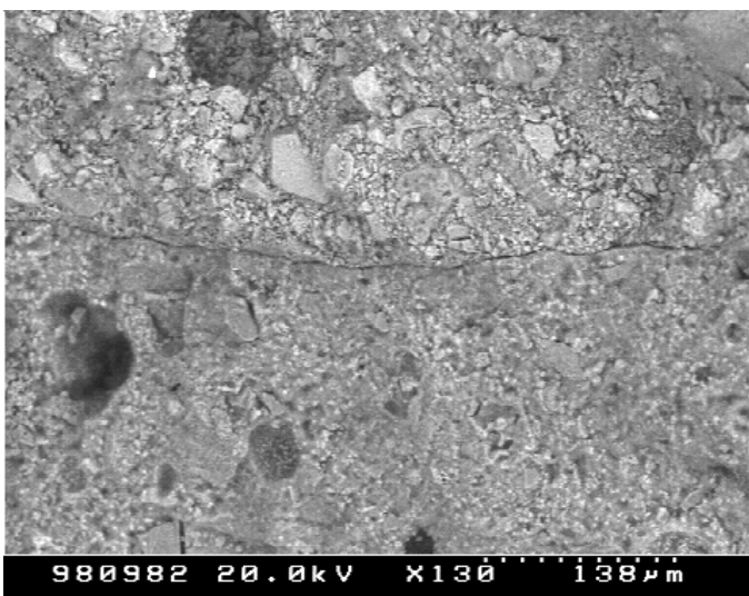
Abb. 47: Kryo-REM-Aufnahme (RE) nach 2,5 h Übergang Porenbeton (unten) zur Frischmatrix (oben) Vergr.: 130x
