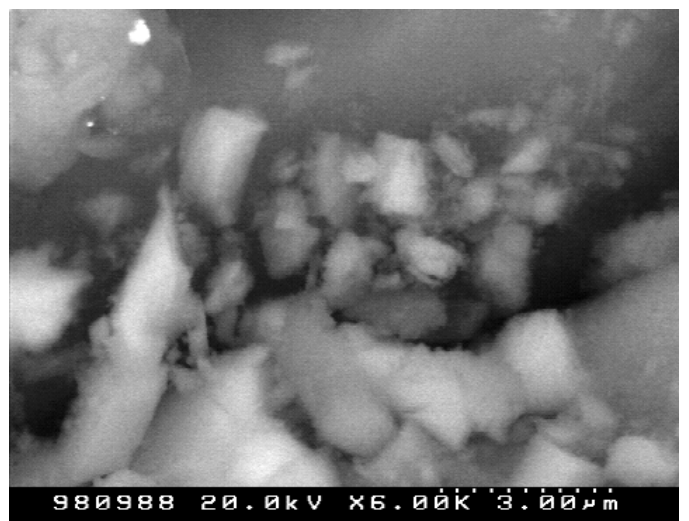
Abb. 8 Kryo-REM-Aufnahme (RE) nach 2,5 h Ausschnitt aus Abb. 37, im Übergangsbereich sind erste Hydratationsprodukte entstanden Vergr.: 6000x
