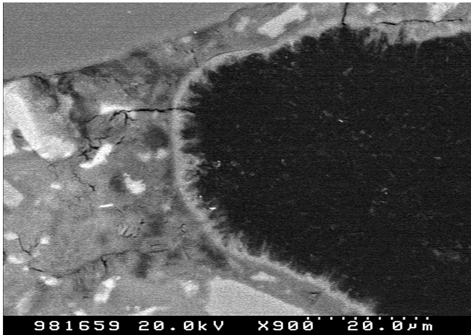
Abb. 61: Im Rasterelektronenmikroskop ist zu erkennen, dass die Kalziumcarbonatschicht aus groben Kristallen zusammengewachsen ist und eine relativ dichte Kruste auf der Innenwand der Pore bildet. [REM-RE]
