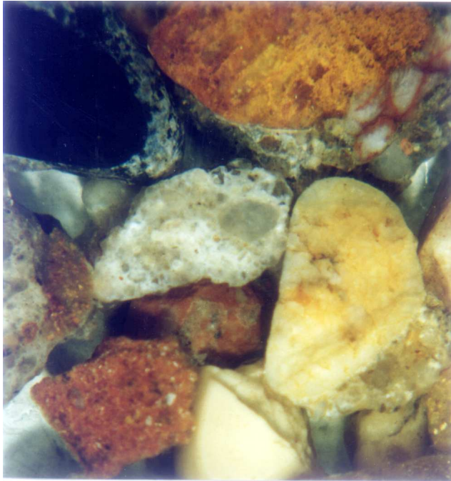
Abb. 2: Betonbruch/Natursandfraktion Es haften nur geringe Mengen Zementsteinmatrix an den ursprünglichen Sandkörnern SteMi-Aufnahme: 8x
